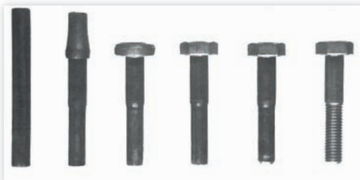
Eine kaltumgeformte Schraube entsteht in sechs Schritten: Draht abscheren, Kopf vorformen, fertigstauen, abgraten, Gewindeteil reduzieren, Gewinde kalt einwalzen.
